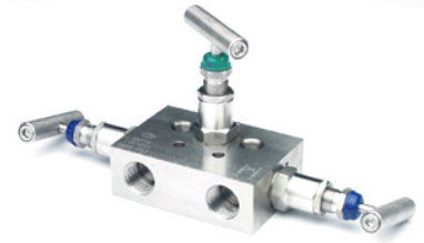
MANIFOLD A 3 VIE Acciaio inox AISI 316 Attacchi 1/2" GAS F o NPT
